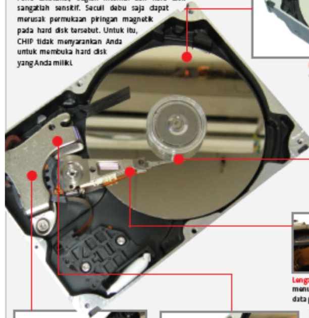
Head: Pentilan kecil di ujung besi tipis ini bertugas untuk membaca dan menulis data pada piringan magnetik.
