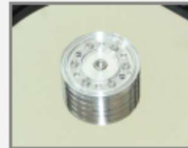
Motor: Satuan RPM yang sering Anda baca merupakan panunjuk kecepatan putaran motor ini.
